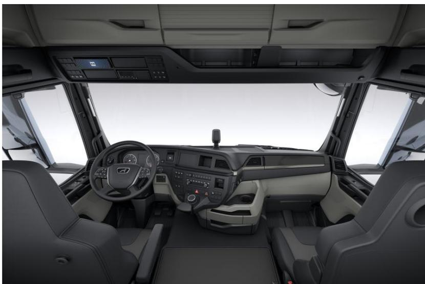
Compte tenu de sa largeur extérieure compacte de 2,24 m, la cabine TM équipée d'un toit de hauteur moyenne est plus légère que les cabines larges G. Elle convient donc parfaitement pour les applications spéciales du transport long-courrier national.
